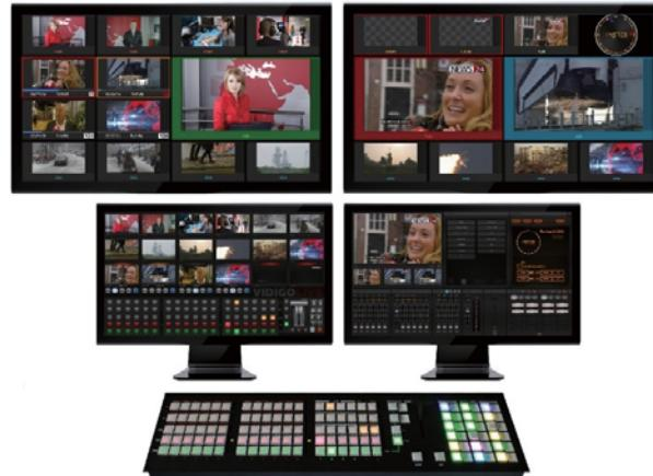
直感的な操作が可能なマルチカメラライブTV制作用ソフトウェアによるスタジオ オートメーションシステム。映像スイッチャー機能、オーディオミキサー機能やビデオ再生機能に加えて、Adobe Flashグラフィックスのリアルタイム再生を実現するグラフィックエンジンを搭載。コンパクトでありながら多機能なシステムです。ロケ中の制作ツールとしても使用でき、移動時はフライトケース1つに収納できます。
