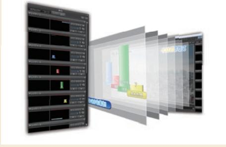
最大16レイヤーまで同時制御可能。タイマー、ロゴ、ロール・スクロールなど、適時に必要なレイヤーを送出制御でき、ダイナミックな演出を一台で実現。
