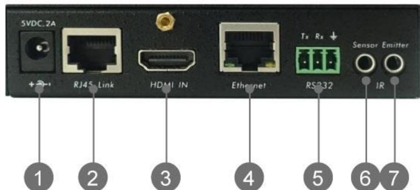
① 電源ジャック : 付属の AC アダプターを接続します。
