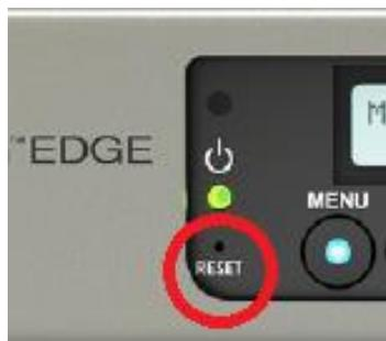
機器が通電している状態で「リセットボタン」をクリップなどで電源 LED が高速点滅をするまで押した後、離して下さい。自動再起動後、工場出荷時状態に初期化されます。
