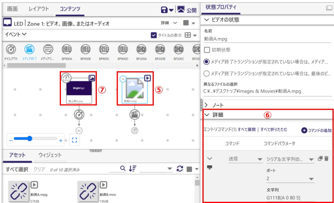
⑤LED を点滅させるコマンドを追加します。登録済みの動画 A のサムネイルをクリックして選択します。
