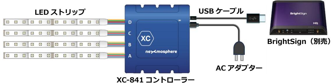
コントローラーの A～D ポートに LED ストリップを接続します。USB ケーブルをコントローラーの USB ポートに接続して BrightSign に接続します。AC アダプターをコントローラーの DC ポートに接続してコンセントから電源を取ります。コントローラーのステータス LED が約 5 秒点滅した後に止まります。
