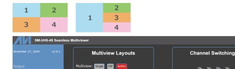
Multiview Layouts > Aspect では、"Full"または"16:9"をプルダウンにて選択できます。Full を選択した場合はウインドウのサイズに合わせて表示します。16:9 を選択した場合はウインドウのサイズを問わず、16:9 のアスペクトのまま表示します。Multiview Layouts > Mode では、2種のプリセットから表示レイアウトを選択できます。Channel Switching の設定欄で各ウインドウに対して入力ポートを選択し、Submit をクリックすると設定値が反映されます。
