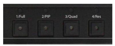
**1/FULL ボタン**: フルスクリーン(1 画面)表示します。このモードでは、1/Full 上部の LED が点灯します。このモード中、ボタンを押すたびに入力ポート 1~4 が順に切り替わり、KVM を含むすべての信号が同時に切り替わります。選択中のポートに対応するボタンの LED が点灯し、現在のポートを示します。
