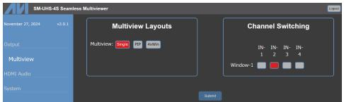
Channel Switching の設定欄で入力ポートを選択し、Submit をクリックすると設定値が反映されます。
