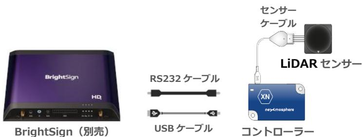
※LiDAR センサーはコントローラーの 001 以外のポートに接続することも可能です。002 ポート等に接続した場合、センサーから BrightSign へ送られるシリアルコマンド、設定変更のために BrightSign から送信するコマンドの一部が変わります。本書では LiDAR センサーを 001 ポートに接続するものとして説明します。
