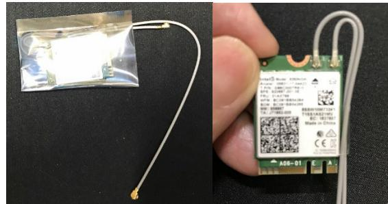
4. モジュールのラベル面を上にして、本体基板と並行の位置に持ち、M2 スロットに取り付けます。端子が見えなくなるまで差し込みます。
