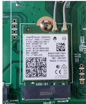
5. 2本のアンテナ線を本体基板の左右にあるアンテナ端子にそれぞれ接続します。(赤で囲った部分)
