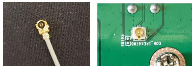
下記の画像のように本体側のアンテナ端子に WiFi モジュール側の端子を接続し、固定します。
