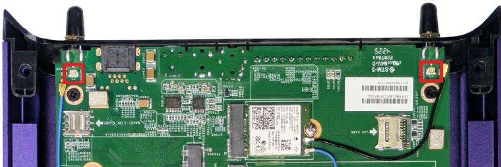
モジュール側の端子が凹、本体側の端子が凸になります。端子同士を合わせて押し込み固定します。
