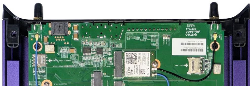
6. 左右のアンテナ端子を接続したら手順 1 で外した底面パネルを本体に被せて 4 箇所をネジで留め直し、底面パネルに WLAN MAC ID ラベルと技適マークラベルを貼ります。
