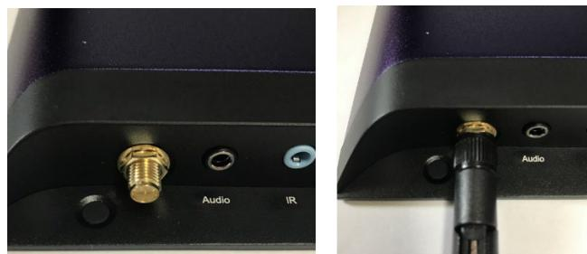
左右のアンテナ端子に WiFi アンテナを取り付けて作業終了となります。
