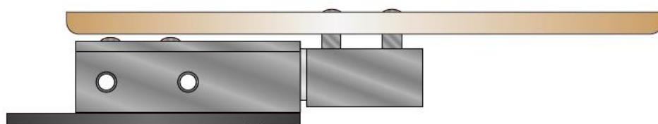
側面のネジ穴で構造物に固定、棚の端の部分を直接固定
