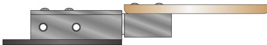
大きい金属ケースは上部のネジを外すことで上蓋部分を取り外すことができます。上蓋を取り外すことでスペーサーなしでより大きな棚（パネル）を中央に設置することができます。
