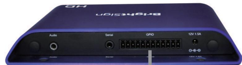
GPIOコネクタ6pin(Phoenix Contact ヨーロブロック/3.5mm)
